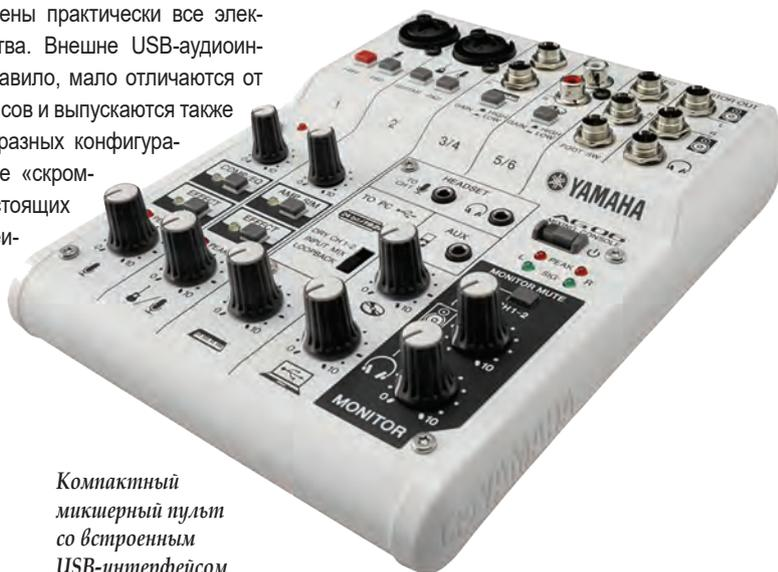
Компактный микшерный пульт со встроенным USB-интерфейсом
