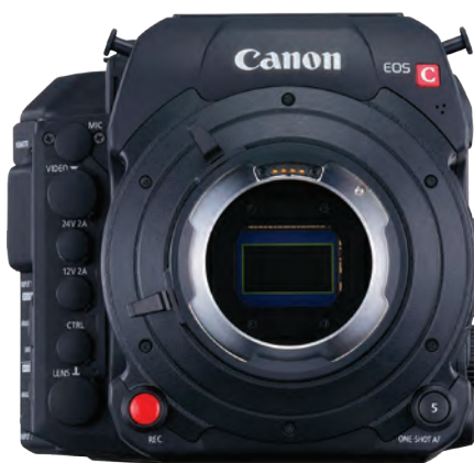
Камера с байонетом PL – хорошо виден сенсор формата Super 35mm
