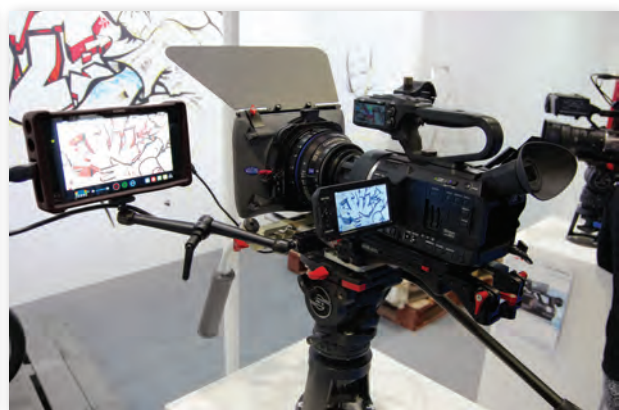
Камера LS300CH с компендиумом и внешним монитором-рекордером Atomos
