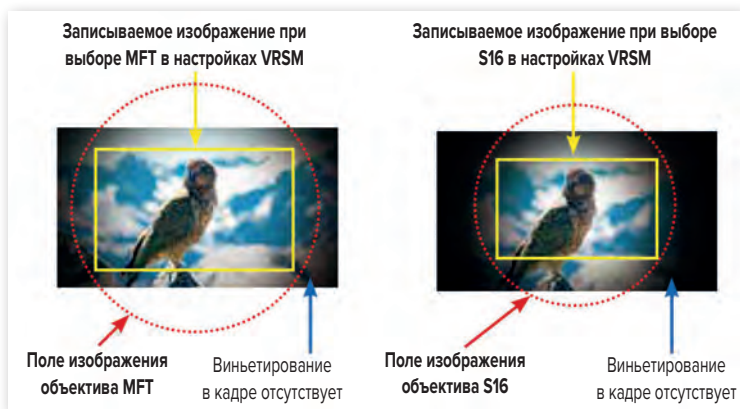
Работа GY-LS300CH с объективами MFT и S16
