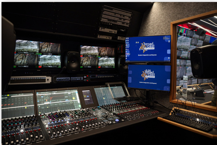
Звукорежиссерский отсек с микшерной консолью Lawo mc 2 56 MkIII
