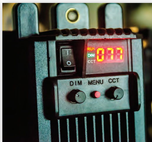
Органы управления прибором и численное табло для отображения параметров
