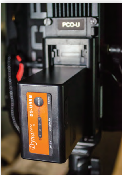
Батарея питания, установленная на площадке, а также разъемы для подключения прибора и батареи к блоку управления
