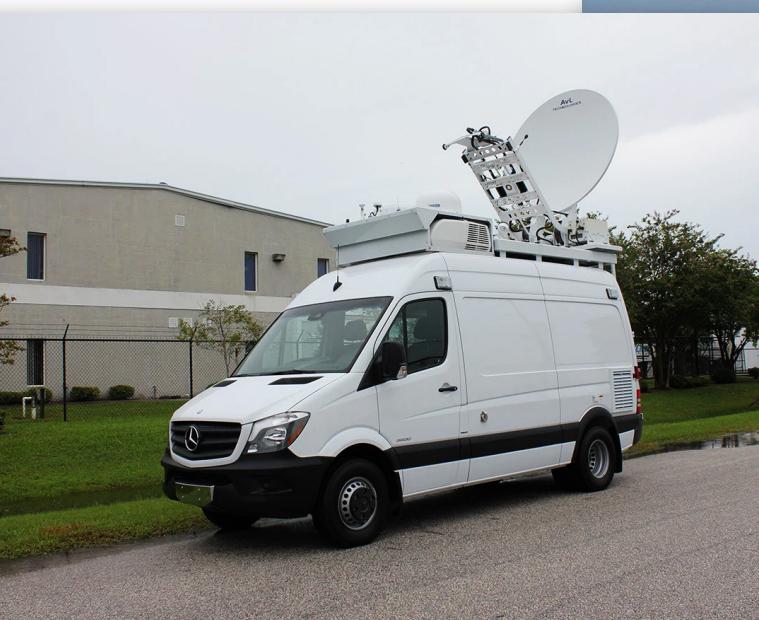
Передвижная станция спутниковой связи
