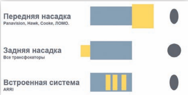
Расположение анаморфотных насадок в объективах различных производителей
