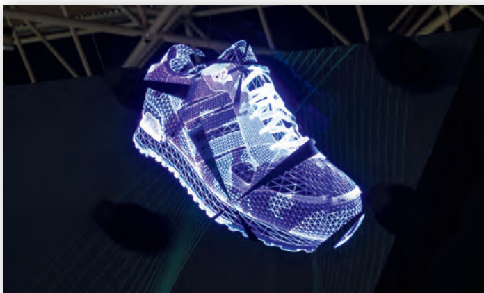
Изображение, сформированное вращающимся пропеллером со светодиодами. О вращении пропеллера можно догадаться по черным секторам, которые зафиксировал фотоаппарат
