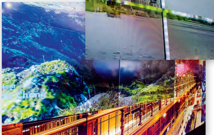
Видеостена, составленная из безрамочных дисплеев, и стык между дисплеями
