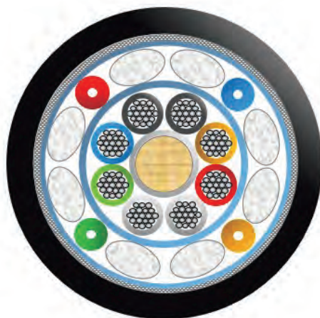
Рис. 7. Структура универсального гибридного кабеля
