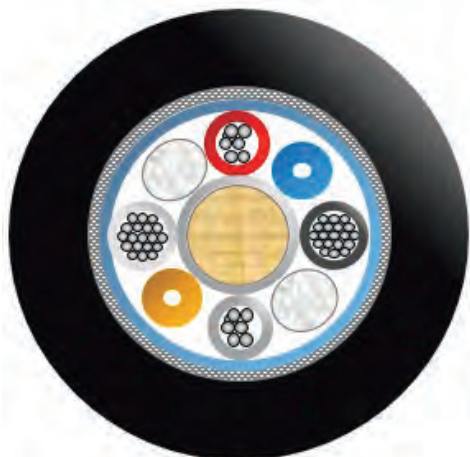
Рис. 5. Структура кабеля для легких камер
