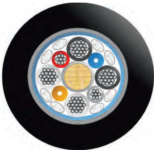
Рис. 1. Гибридный оптический кабель в разрезе
