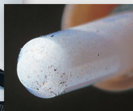
Сверху вниз: инструмент Canare ASPT-1 для снятия обжимного цилиндра, извлечение обжимного цилиндра, ферула до и после очистки
