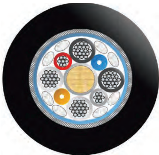
Рис. 1. Гибридный оптический кабель в разрезе
