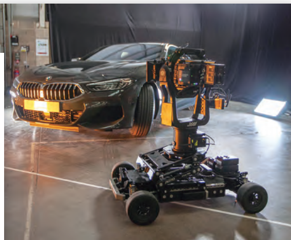
Рис. 5. Съемочная система на основе камеры и стабилизированной головки ARRI и дистанционно управляемой тележки Agito
