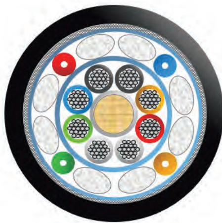
Рис. 7. Структура универсального гибридного кабеля
