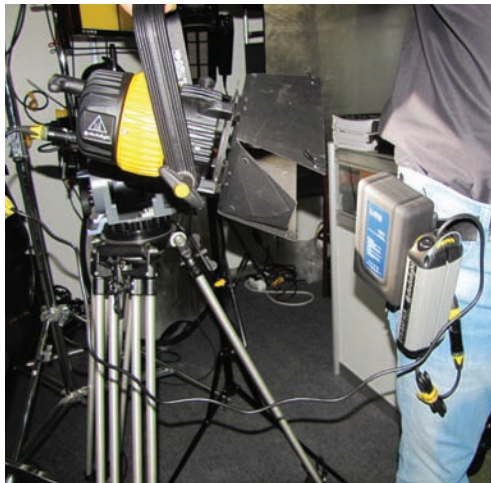
DLED-9, получающий питание от мобильной батарейной системы
