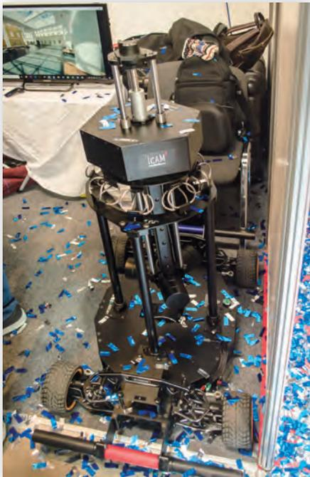
Тележка iSteadicam с телескопической колонной iCam
