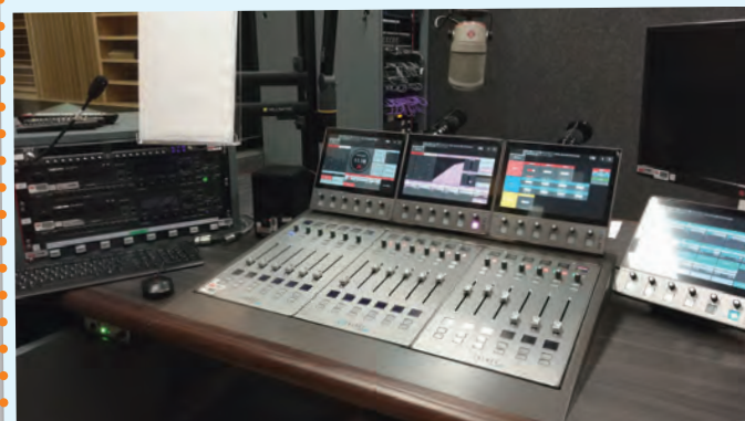
Микшеры Calrec Type R, установленные на радиостанции RTM (вверху) в Малайзии и на радиостанции RTHK в Гонконге
