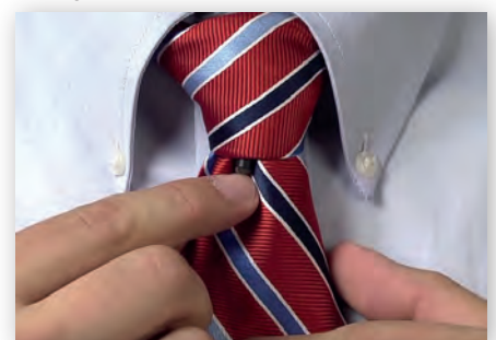
Пример установки микрофона DPA 4060 в узле галстука
