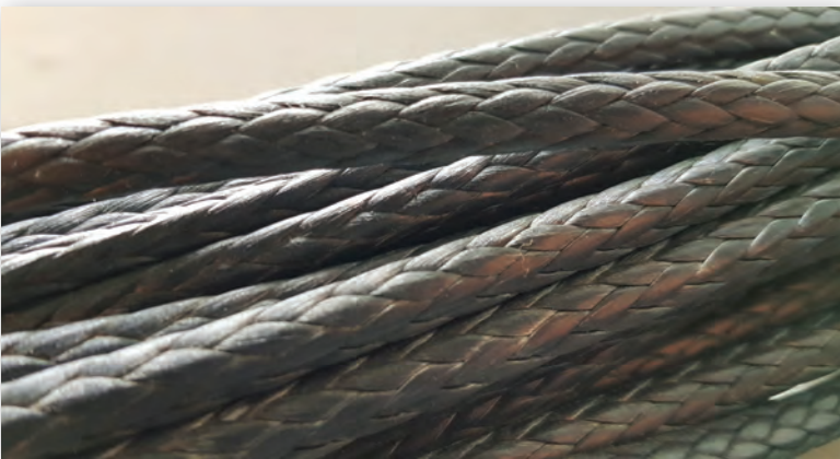
Рис. 5. Оплетка из материала Дупеета – волокна в ней параллельны друг другу
