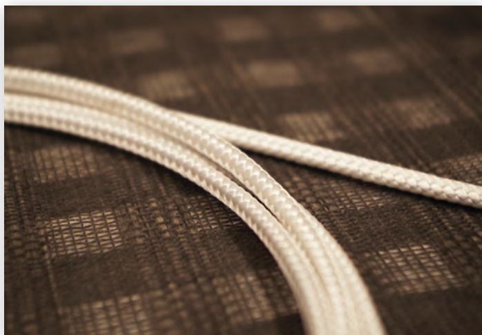
Рис. 2. Бухта кабеля WPO Дунеета и его оплетка
