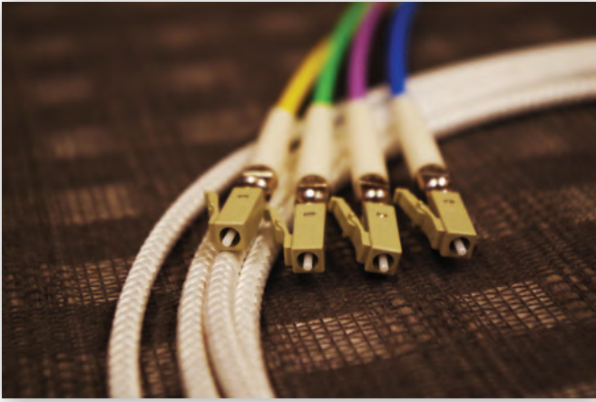
Рис. 3. Кабель, состоящий из четырех волокон
