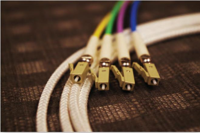
Рис. 3. Кабель, состоящий из четырех волокон
