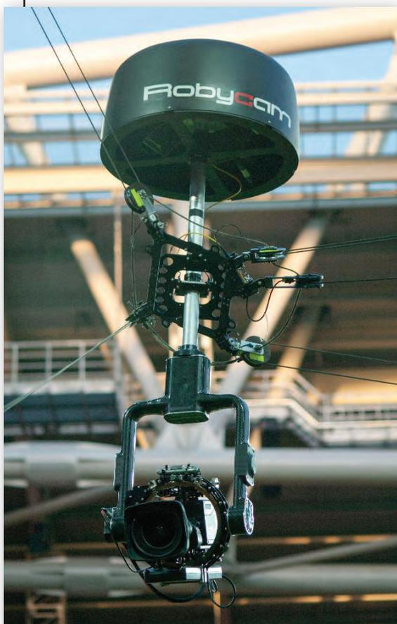
Рис. 1. Камера на стабилизированном подвесе
