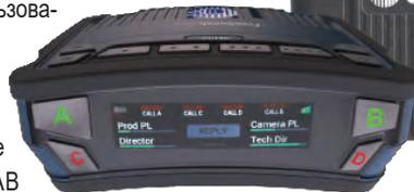
малой задержкой. А возможность масштабирования позволяет объединять в общую сеть до 100 и более поясных терминалов и 64 трансиверов. Кроме того, FreeSpeak Edge без проблем сочетается с FreeSpeak II, работающими в диапазонах 1,9 и 2,4 ГГц, что дает сразу три рабочих диапазона в рамках одной системы связи.
