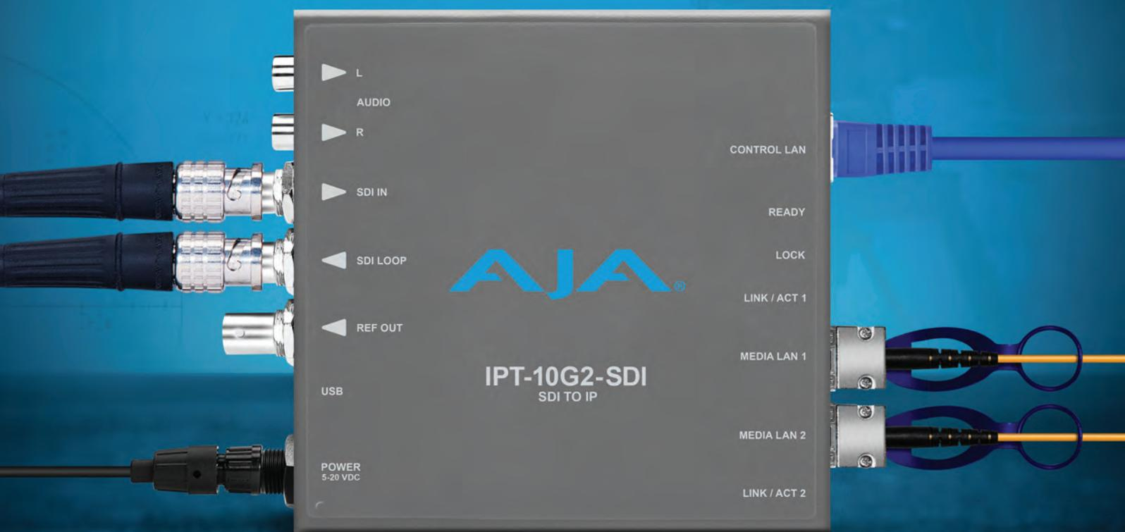
Новые IP-миниконвертеры AJA IPT-10G2-HDMI и IPT-10G2-SDI позволяют подключить HDMI HD- или 3G-SDI-источники к сети SMPTE 2110, обеспечивая полную совместимость и высокую производительность. Управление и конфигурирование IPT-конвертеров осуществляется по LAN через встроенный web UI. Поддерживаются также протоколы NMOS, Ember+ и AJA REST API.
