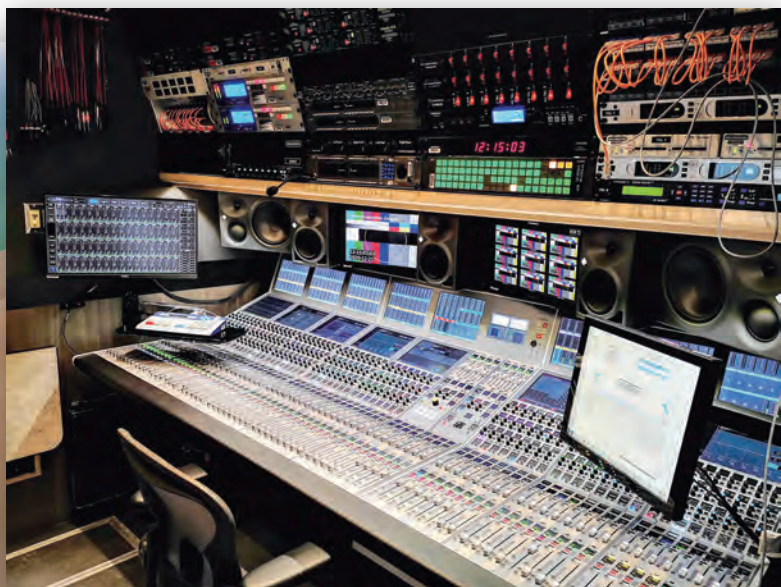
Цифровой аудиомикшер Calrec Apollo в звукорежиссерском отсеке Gateway
