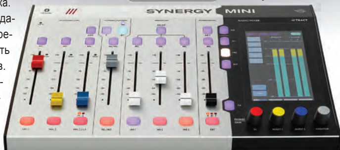
Цифровой аудиомикшер SYNERGY MINI с ПО Djin SYNERGY
