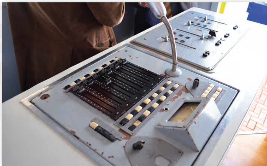
Один из первых аудиомикшеров, использовавшийся в ПТС португальского ТВ в 1960-х годах
