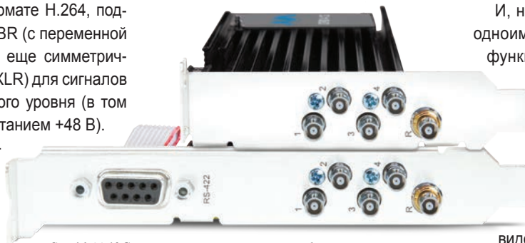
Corvid 44 12G: полноразмерная и низкопрофильная версии
