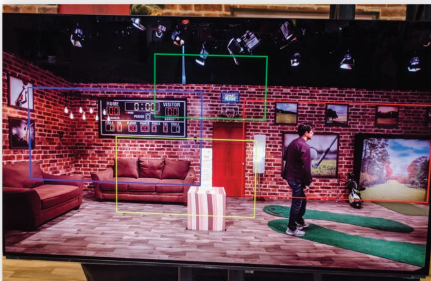
8K-камера AK-SHB800GJ и четыре HD-окна, вырезаемые из 8K-кадра
