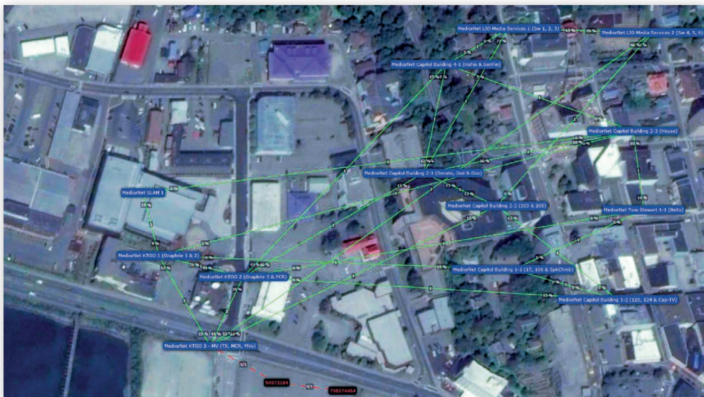
Топология системы MediorNet, используемой каналом КТОО
