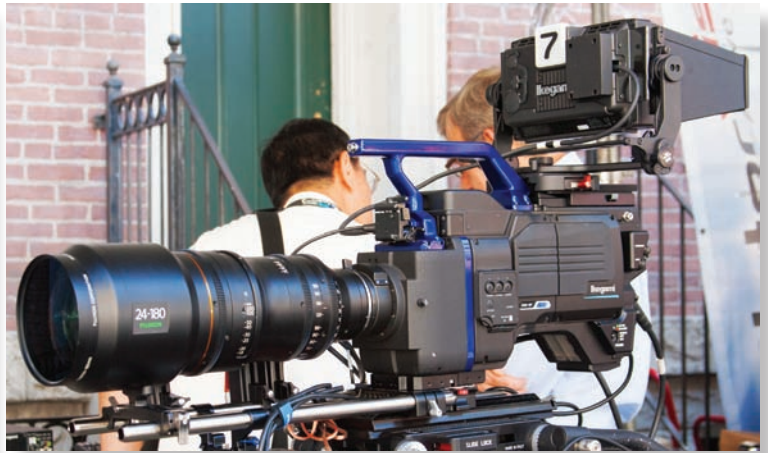
Камера HDK-97ARRI с вариообъективом Fujinon
