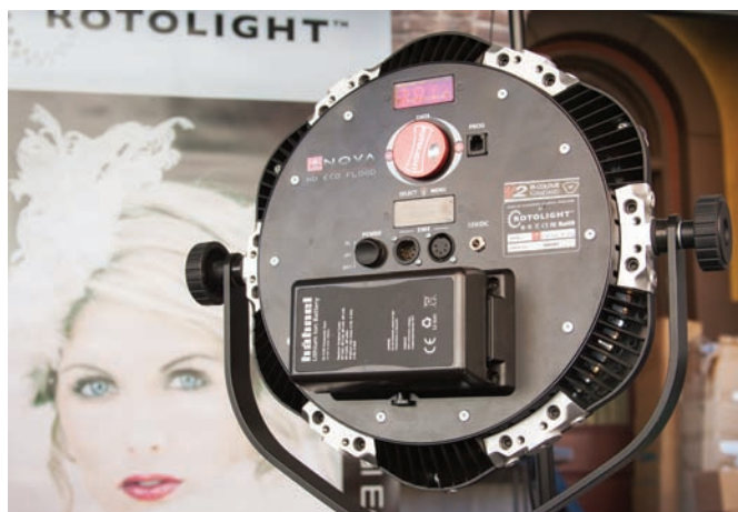
Светодиодный осветительный прибор Rotolight Anova – органы управления
