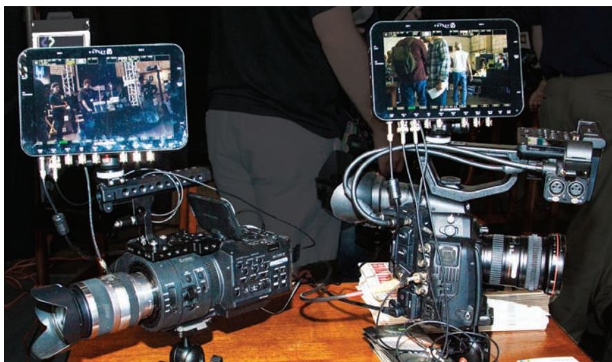
Рекордеры Convergent Design Odyssey 7Q на камерах разных типов
