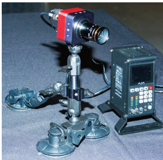
Камера Flare 2KSDI, подключенная к рекордеру AJA KiPro Quad
