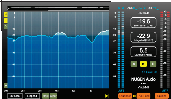
Осциллограмма соседних фрагментов программ с одинаковыми пиковыми уровнями, но разным динамическим диапазоном
