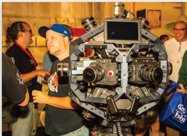
Система сферической съемки на базе камер RED
