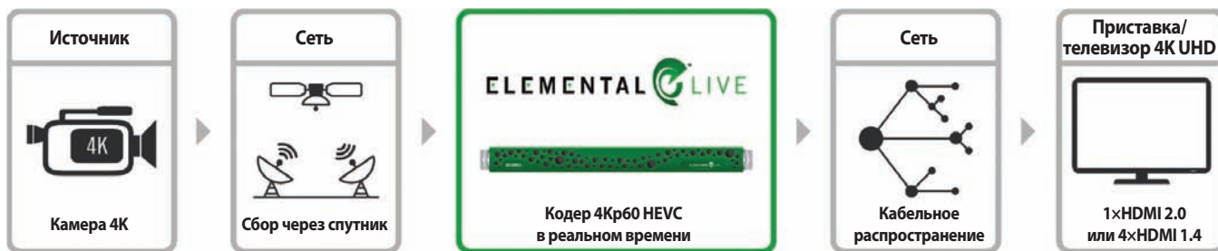
Рис. 7. Типовой процесс прямой трансляции 4K в 2014 году
