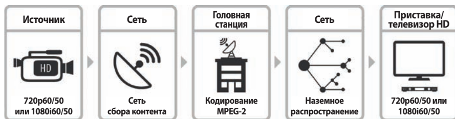
Рис. 2. Типовой технологический процесс HD-вещания на базе MPEG-2
