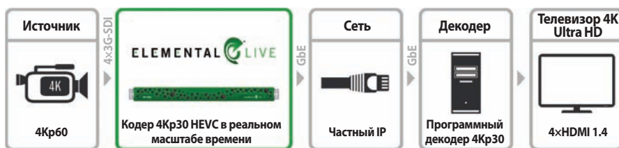
Рис. 3. Рабочий процесс первой прямой трансляции в формате 4Kp30
