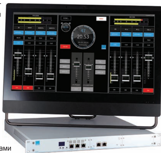
Системный блок видеомикшера crystal и монитор с интерфейсом ПО crystalCLEAR
