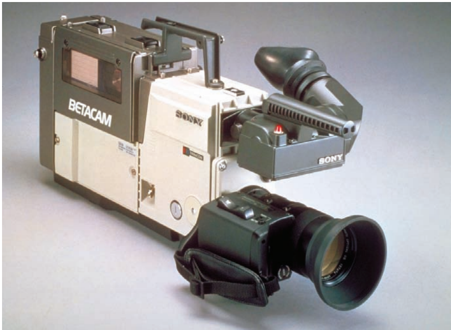
1982 год - одна из первых видеокамер Sony формата Betacam со стыкуемым BM BVW-1
