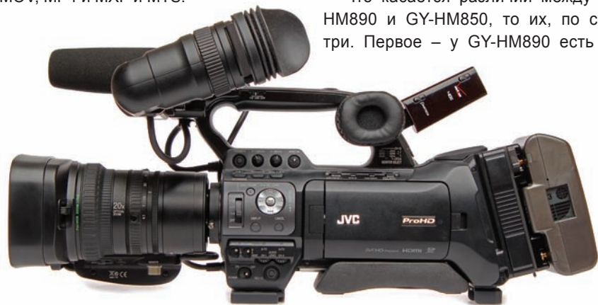
Видеокамера GY-HM890 с подключенным к ней модемом 3G/4G LTE
