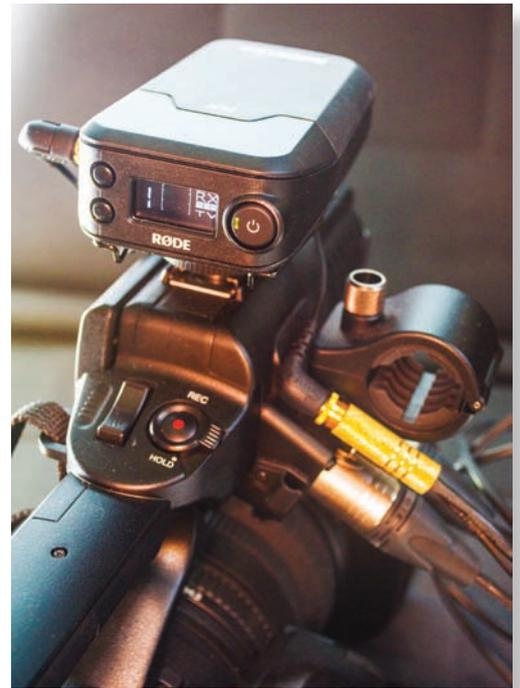
Приемник, установленный на камере JVC GY-HM600 и подключенный к аудиовходам через переходник
