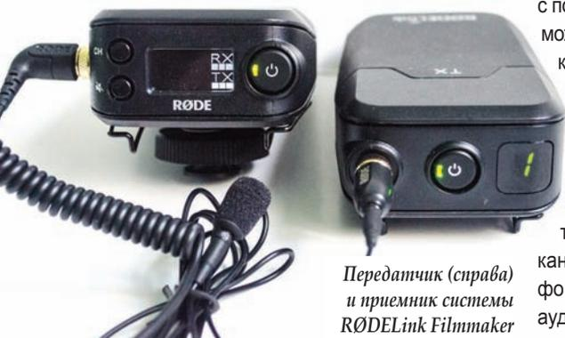
Передатчик (справа) и приемник системы RØDELink Filmmaker
