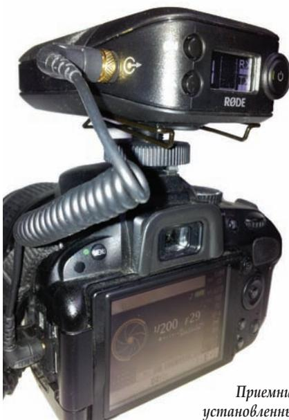
Приемник, установленный на фотокамере Nikon D5100
