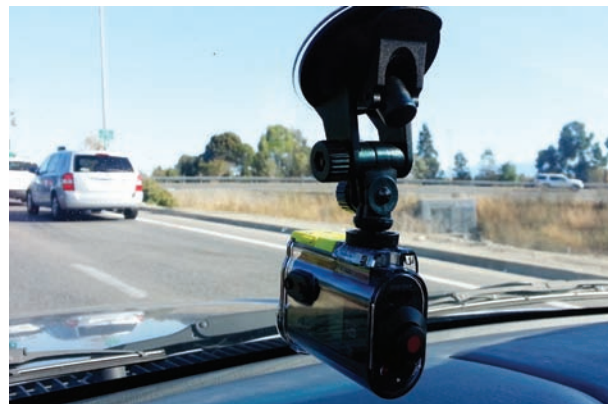
Крепление камеры к ветровому стеклу автомобиля с помощью присоски и шарнирного подвеса
