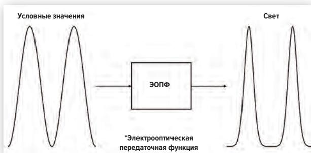
Рис. 4. Синусоидальные волны в условных значениях приводят к искажению световой волны и появлению ступенчатости
