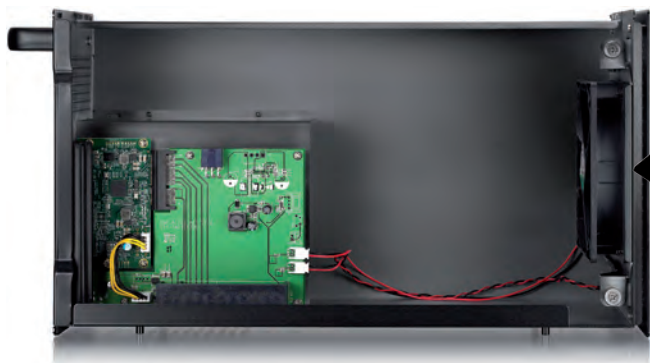
AKiTiO Node со снятой боковой крышкой
