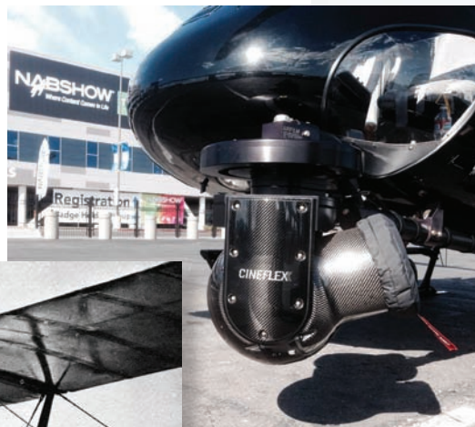
Гиростабилизированная съёмочная система, подвешенная под фюзеляжем вертолета
