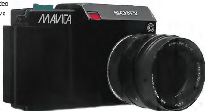
Рис. 13. Прототип аналоговой электронной фотокамеры Sony Mavica
