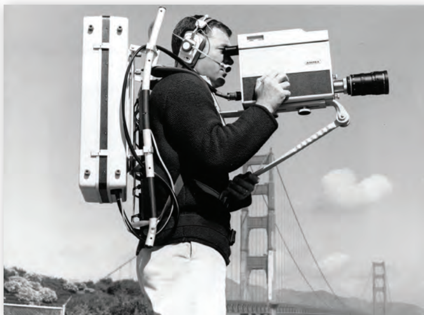
Рис. 9. «Портативный» рюкзачный BM Ampex VR-3000 типа Quadriplex на базе 2» ленты
