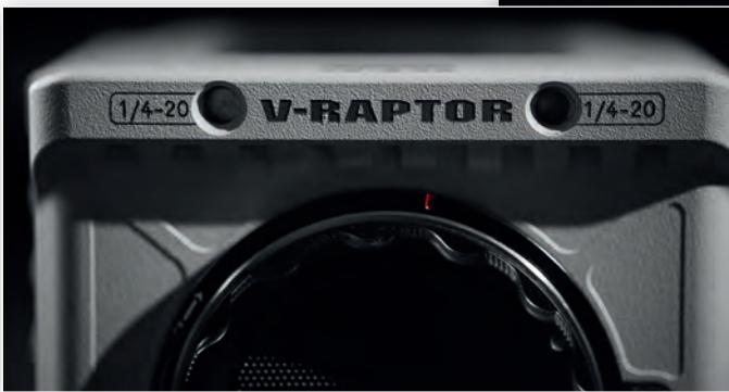
Резьбовые отверстия для крепления аксессуаров в верхней части корпуса камеры
