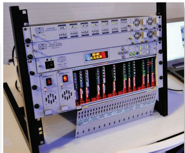
Аппаратура «Профитт» (сверху вниз): модульная система PROFLINK, универсальный матричный коммутатор PSOE-3232-3G, коммутатор перехода на резерв PRSD-4069 и модульная система PROFLEX
