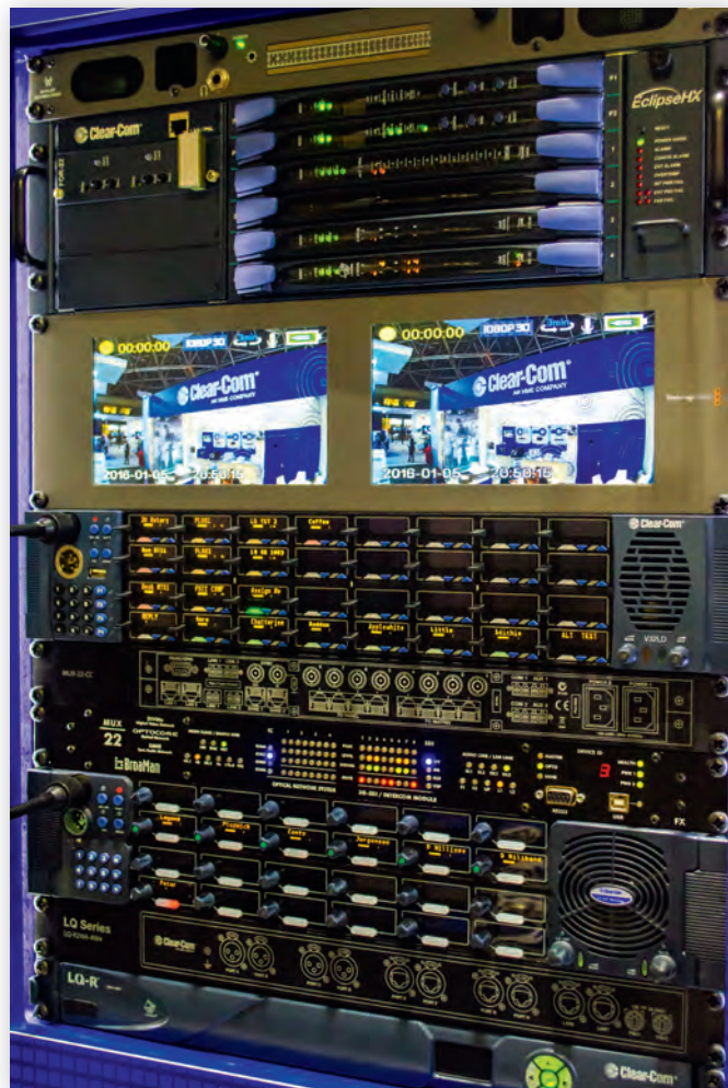
Оборудование Clear-Com: вверху – матрица Eclipse HX, внизу – устройства серии LQ
