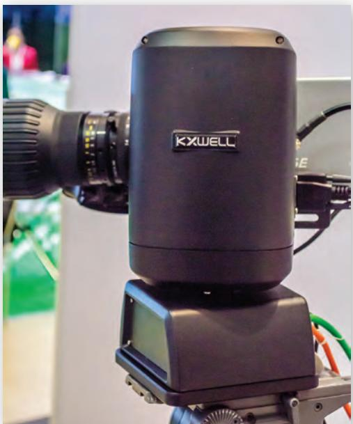
Роботизированная головка KXWELL, несущая камеру Ikegami HDL-45E
