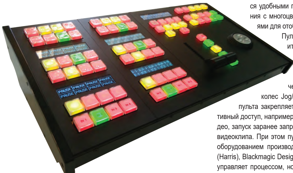
Пульт MTR-RCU для управления медиасервером «Атлас-Фрактал» и другими устройствами
