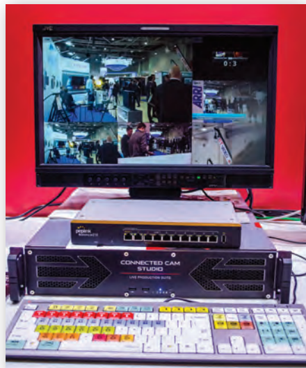
Комплекс видеопроизводства и прямых трансляций JVC Connected CAM Studio
