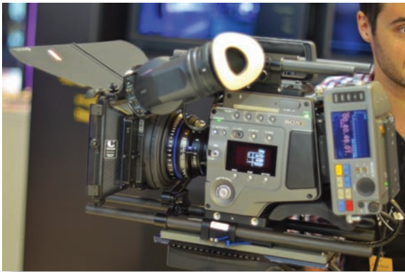
Цифровая кинокамера Sony F65
