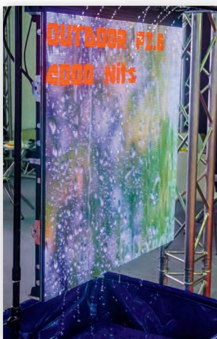
Водозащищенный светодиодный модуль
